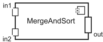
Gráfico 6: Un componente con cuerpos en UML 2.0. Tomado de Ivers y otros (2004)
